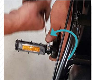
3- Répétez les étapes 1 et 2 pour le côté gauche en visant dans le sens anti-horaire la pédale L sur l'autre manivelle.
