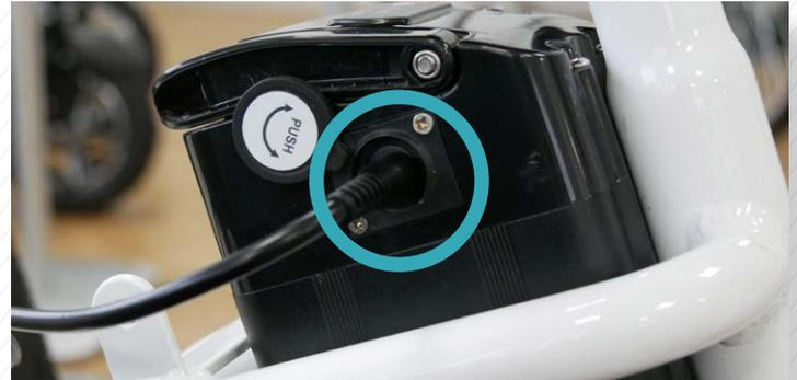
6. Quand le chargeur est correctement connecté, la lampe rouge s'allume. Cela vous indique que la batterie charge normalement. Le chargeur passe au vert et se coupe lorsque la batterie est chargée.
